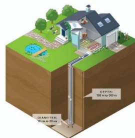
Sonde géothermique verticale
